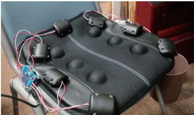
図 3 振動モータを取り付けた実験用シート Fig. 3 Vibrators on experimental seat.
