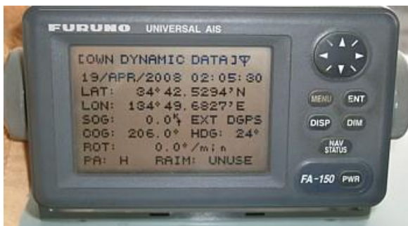
図 5 船舶自動識別センサ (FA-150)
