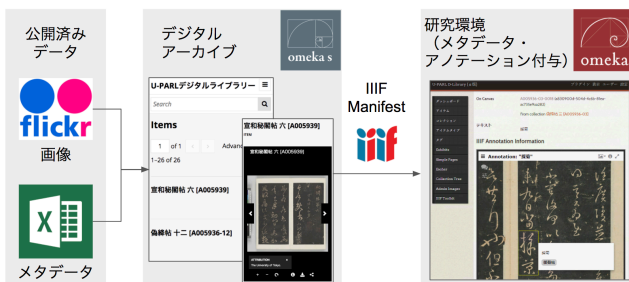
図 2 Omeka を用いたデジタルアーカイブと研究環境 Figure 2 System overview with Omeka.
