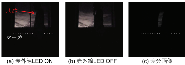
図 3 (a), (b) 赤外線 LED を点灯および消灯して撮影した画像。(c) 撮影した画像から計算した差分画像
