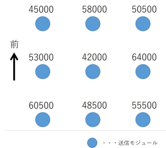
図 5 送信モジュールの配置
