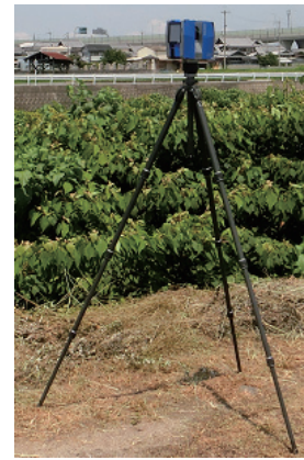
図 1 地上設置型レーザスキャナ (FARO Focus3D)
