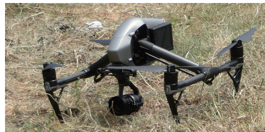
図 2 カメラ搭載 UAV (DJI Inspire2)
