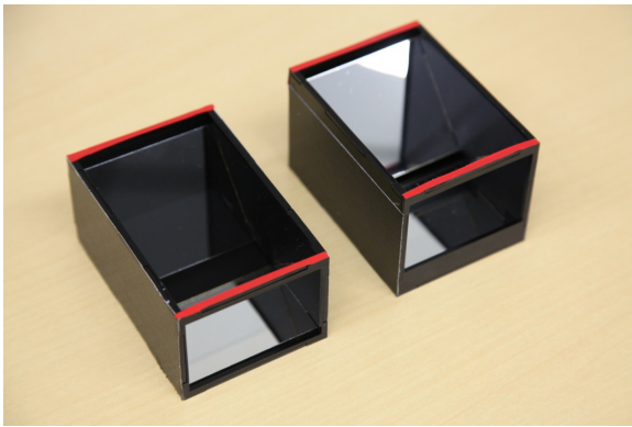
図 7 作成した実験装置, 左: V 字式, 右: DR 式
