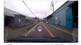
図18 かすれている道路標示の検出(5m)
