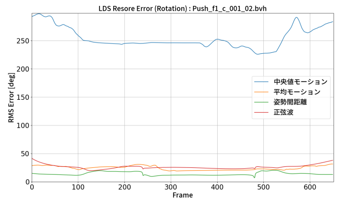
図 6 壁押し動作における全関節の回転角の誤差 Fig. 6 Rotation RMS Error of "Push" motion
