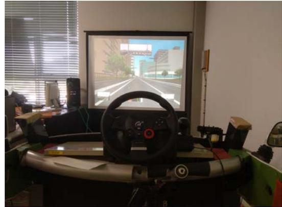
図2 評価用ドライビングシミュレータ
