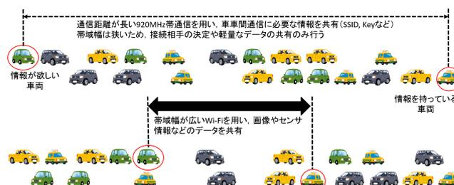
図3 2波長通信システム概要
