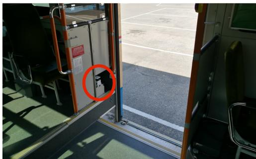
(b) 後扉に設置した計測デバイス
