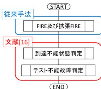
図 5. 本手法のテスト不能故障判定フロー
