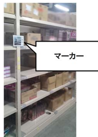
図 5 マーカーの設置
