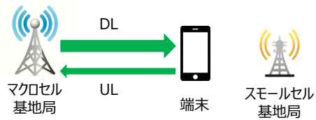
図 3 ダウンリンクとアップリンクを共にマクロセル基地局に接続 (case1)
