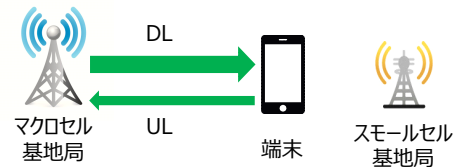
図 1 ダウンリンクとアップリンクを共にマクロセル基地局に接続 (case1)
