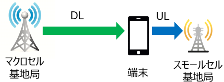
図 4 ダウンリンクをマクロセル基地局に、アップリンクをスモールセル基地局に接続 (case2)
