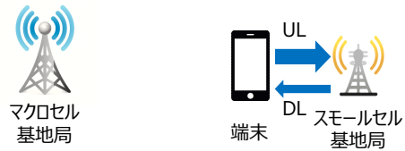
図 6 case4 ダウンリンクとアップリンクを共にスモールセル基地局に接続 (case4)
