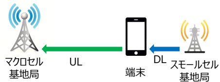
図 5 ダウンリンクをスモールセル基地局に、アップリンクをマクロセル基地局に接続 (case3)
