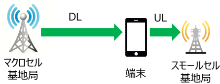
図 2 ダウンリンクをマクロセル基地局に、アップリンクをスモールセル基地局に接続 (case2)
