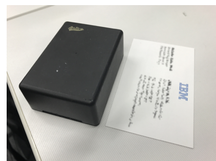
図 2 設置したBLEビーコン
