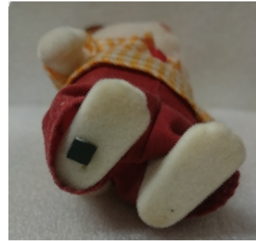
図 4 人形底部に貼付した RFID タグ
