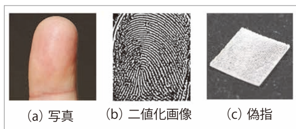
図-8 市販のスタンプ作成機による偽指の作成手順
