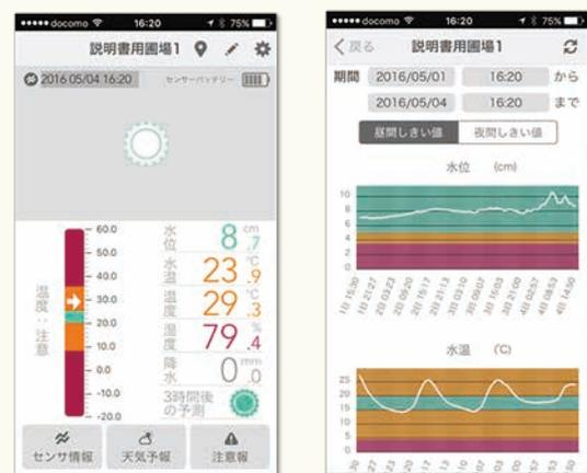
図-1 スマートフォンでの水田センサ確認画面
