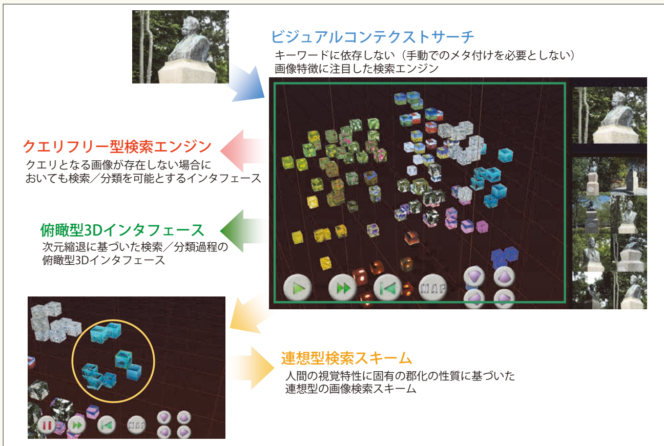
図-1 Image Vortexのインタフェース(文献2)より抜粋). データベースに蓄積されている画像を俯瞰して閲覧する3次元空間インタフェースを導入することで、キーワード等のクエリ(質問)を必要とせず、効率良く希望の画像に辿り着くことができる
