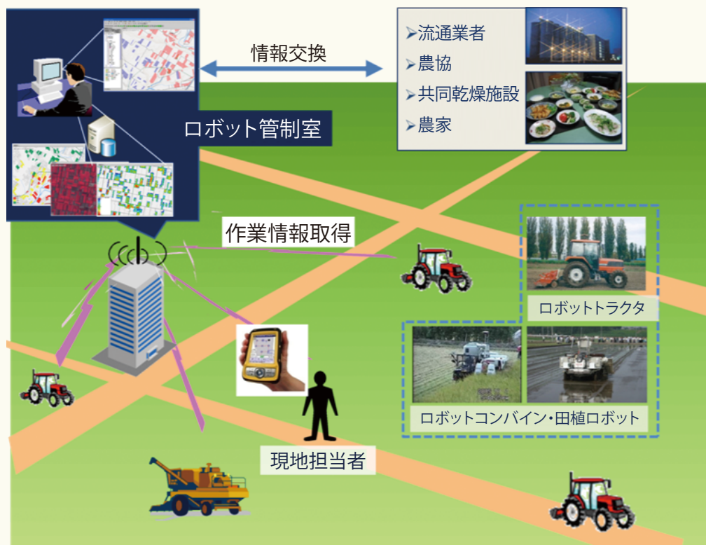
図-2 遠隔監視による完全無人作業システム
