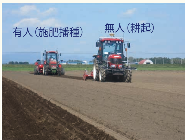
図-1 ロボットトラクタ施用方法の一例（有人・無人の随伴型）
