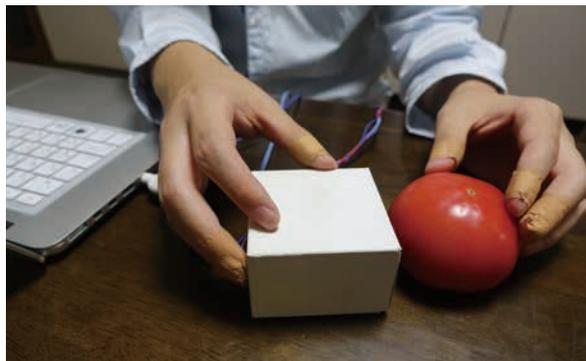
図-3 最終プロトタイプでトマトの鮮度を測っているところ。1個につき対角線方向に4カ所測る
