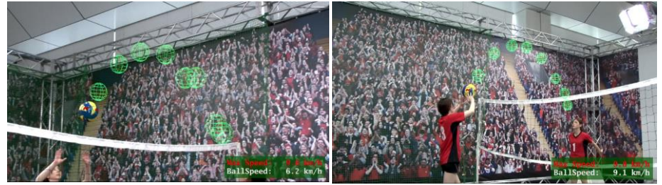
図 4. 映像合成結果出力例．実ボール位置には NHK ロゴ CG を重畳，軌跡は 3 フレーム間隔でワイヤーフレーム描画した．右下に計測スピードを表示した．
