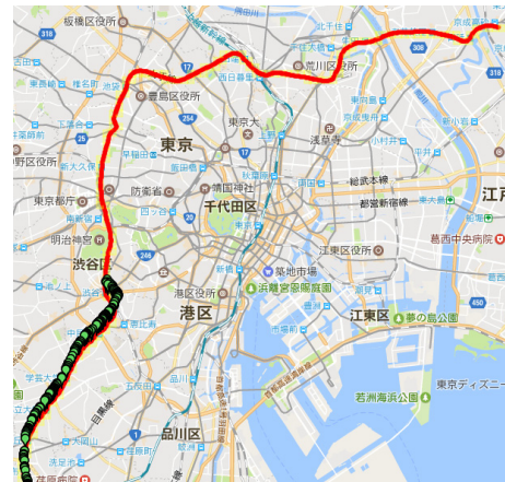
図 7 複数の路線の近似線分が誤ってグループ化された箇所 Fig. 7 Area where multiple lines were misgrouped.
