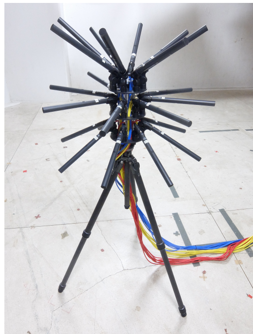
図 5 鋭指向性マイクを用いた“はりねずみ”マイクアレイ Fig. 5 The Hedgehog array using narrow directional microphone.
