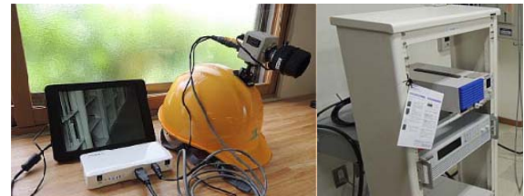
図4 小型カメラ, タブレットモニタ, 可搬型バッテリー, 電圧印加装置
