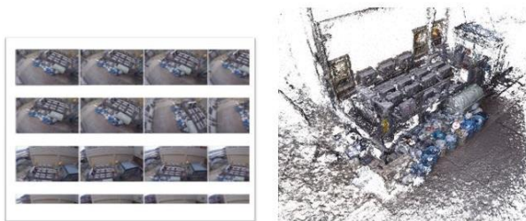
図 3: 画像群(左)と SFM による 3 次元点群(右)
