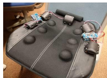
図2 振動モータを設置したシート
