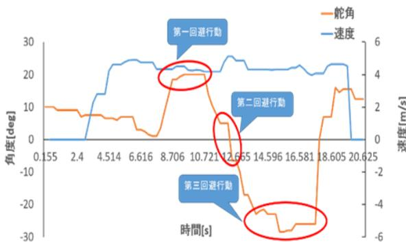
図6 静止障害物回避時の速度と舵角
