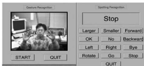
図1 パソコンのカメラと対面して人物のジェスチャ認識。パソコン画面の右上に小型のビデオカメラがついている。下図はコンピュータに指示できるジェスチャの種類を示す 9) 。それぞれの指示内容を表すジェスチャは区間動画像であるが、ここではその中の特徴的な1フレーム画像のみを示している。
