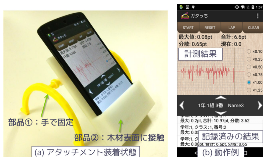
図 7 表面粗さ計測機能の動作例
