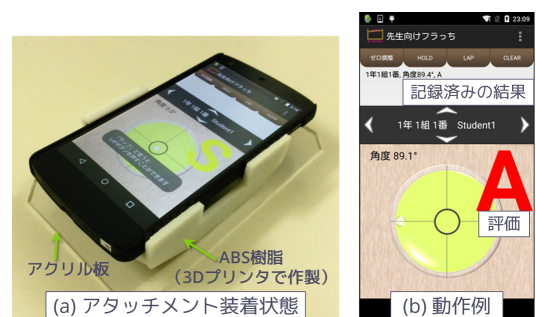
図 5 角度計測機能の動作例
