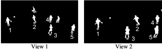
図 14 検出された選手およびボールのシルエット。選手については、地面に足が接しているという前提を利用して、地面の平面射影行列により与えられる射影関係から別のカメラで撮影されたシルエットとの対応を自動判定する
