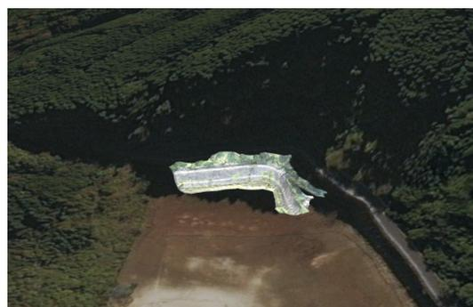
図 3: 3次元地図と3次元形状データの重ね合わせ表示
