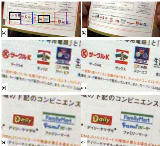
図 28 175 フレームで構成する時系列画像の、(a) 先頭フレームと、(b) 最終フレーム ( 640 \times 280 [画素] の領域を表示した). 注目領域を、5 個の矩形で表す. (c)(e) (a) の 2 個の黒い矩形領域に対する従来のデモザイキング処理を Bi-Cubic 補間で拡大した結果. (d)(f) 同じ領域に対するダイレクトカラー超解像処理結果
