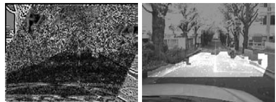
基準画像と射影変換した参照画像の差分画像 平面抽出結果 (明るい領域が抽出された平面領域)
