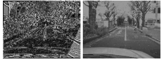
基準画像と射影変換した参照画像の差分画像 平面抽出結果 (平面領域が抽出されていない)
