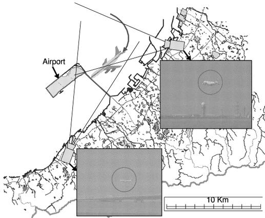
図1 広範囲に配置されたカメラの上空にある移動物体を用いたキャリブレーションの例
