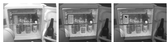
(a) 原画像 (b) 缶として認識された領域 (c) 認識結果 (緑領域: 2 次的特徴)
