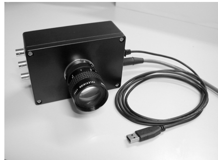
図 3 三相時間相関イメージセンサを用いた時間相関カメラ．左側の 3 個の BNC コネクタより参照信号を供給し，3 本の相関ビデオ出力を A/D 変換して USB 経由で PC に出力する
