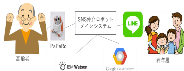
図3 ソーシャルメディア仲介ロボットのアーキテクチャ
