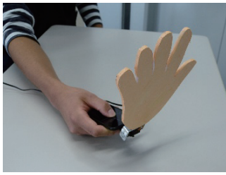
図 15 スマートフォンを用いた小型挙手ロボット
