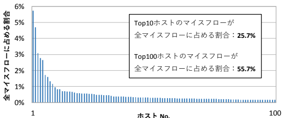
(b) Top100 ホストのミスフローが全ミスフローに占める割合
