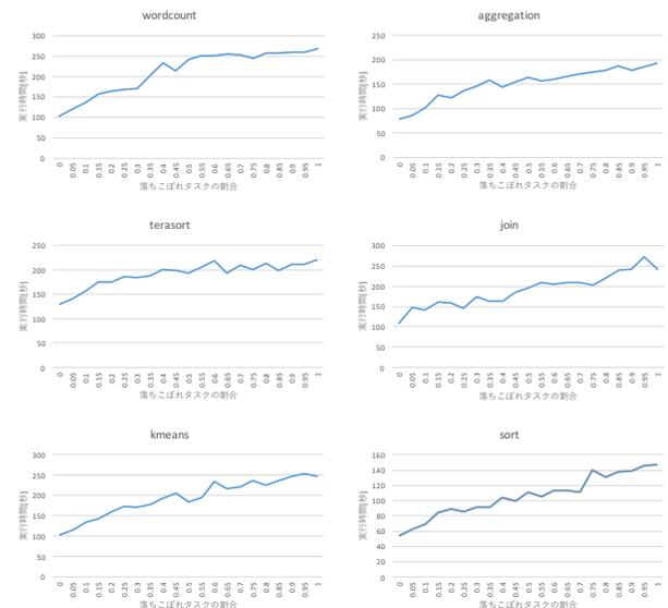
図 4 ワークロードごとの落ちこぼれタスクの割合による影響 (CPU 制限の場合)
