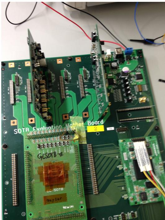
図 3 GC-SOTB 評価環境 (左上: 電源ボード, 左下: GC-SOTB, 右下: FPGA ボード)
