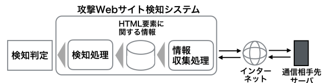
図 2 攻撃 Web サイト検知システムの概要図
