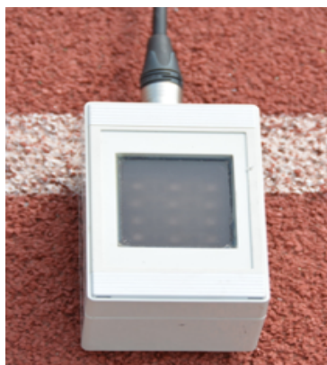
図 1 光刺激スタートシステムのシグナル部 (一般社団法人日本聴覚障害者陸上競技協会より)
