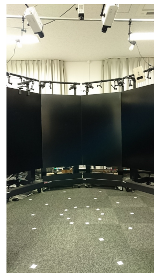
図 7 システムの設置例。天井部に俯瞰カメラを追加している。 Fig. 7 System implementation example. An overhead camera is added on the ceiling.
