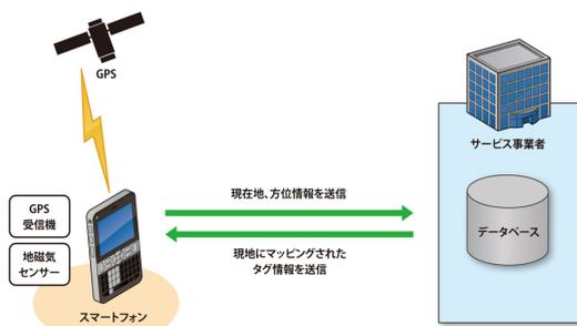
図 1 ロケーションベース AR の仕組み[9]
