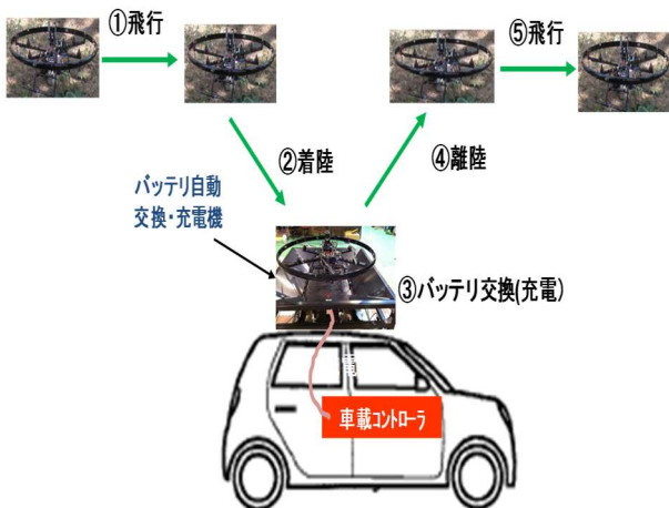
図6 ドローンのバッテリー交換(充電)車 Figure 6 Drone's battery replacement (charging) car
