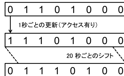
図 6 エージングアルゴリズム用のメモリ参照履歴の更新
