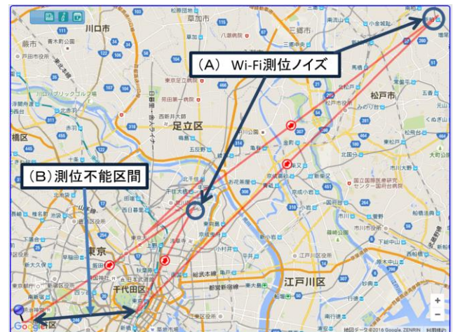
図 2-1 Android SDK 標準機能(Wi-Fi 測位)での地下鉄測位
